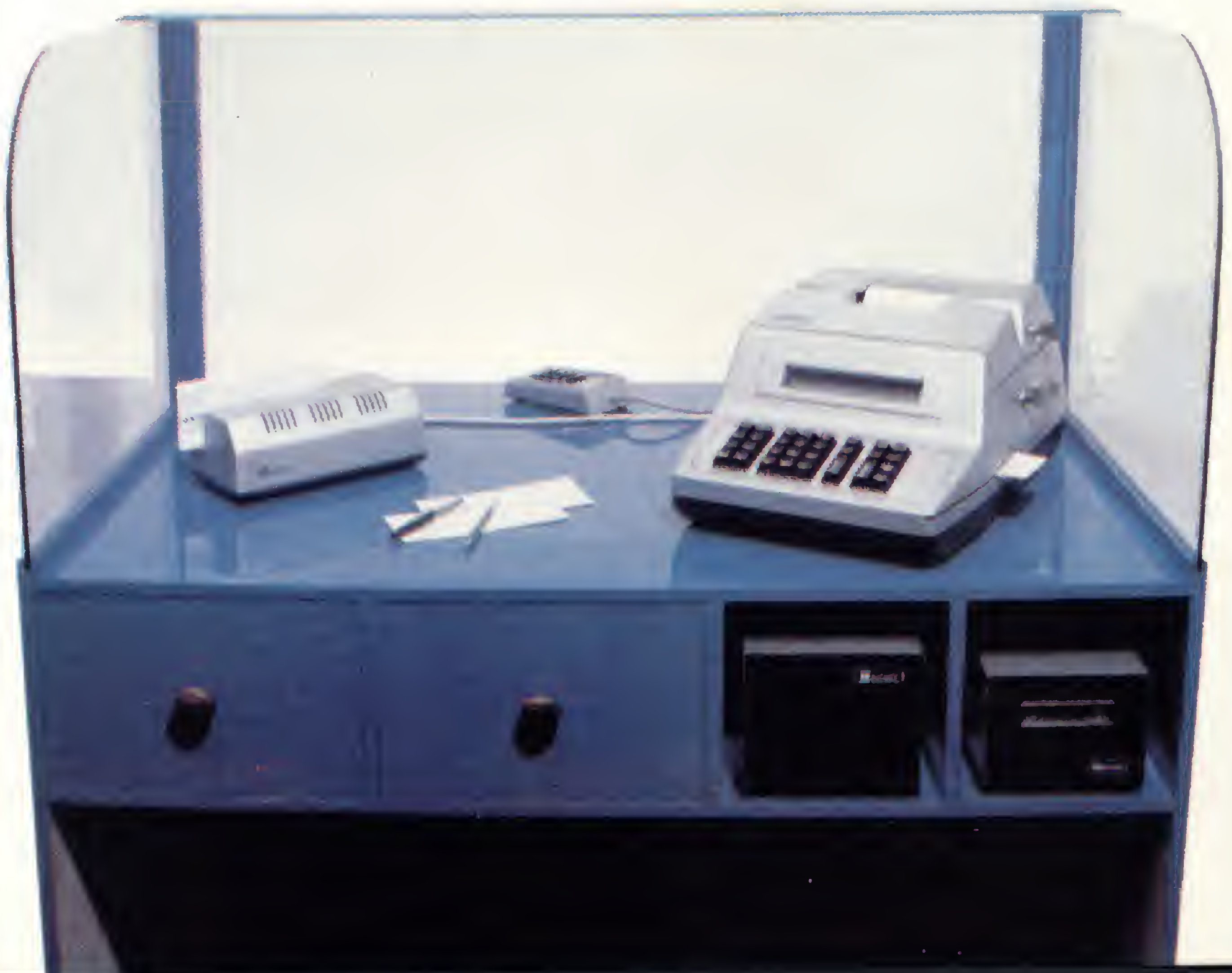
Terminais de caixa "on-line" ou "off-line", com gravador, bateria e periféricos.
